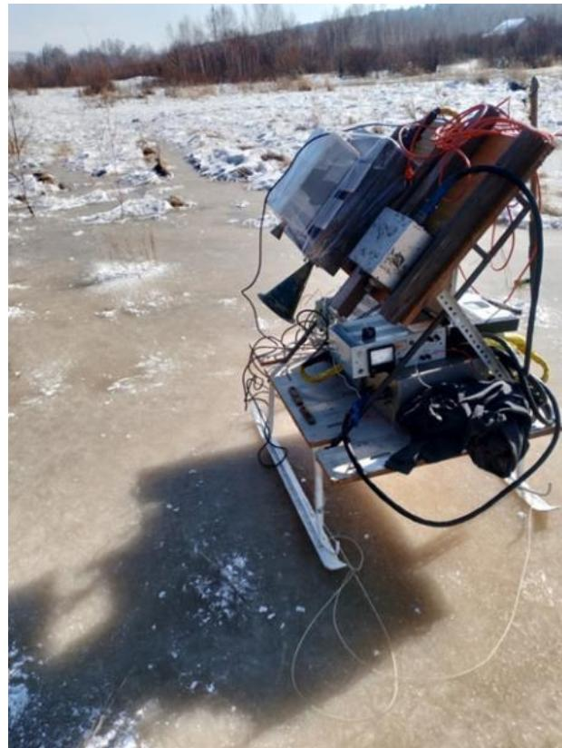
Для измерения радиотеплового излучения исследуемого участка наледи использовались микроволновые радиометры на длины волн 0,88 см и 2,3 см и инфракрасный радиометр с диапазоном длин волн 8...14 мкм, расположенные на санях под углом наблюдения  $45^\circ$ .
